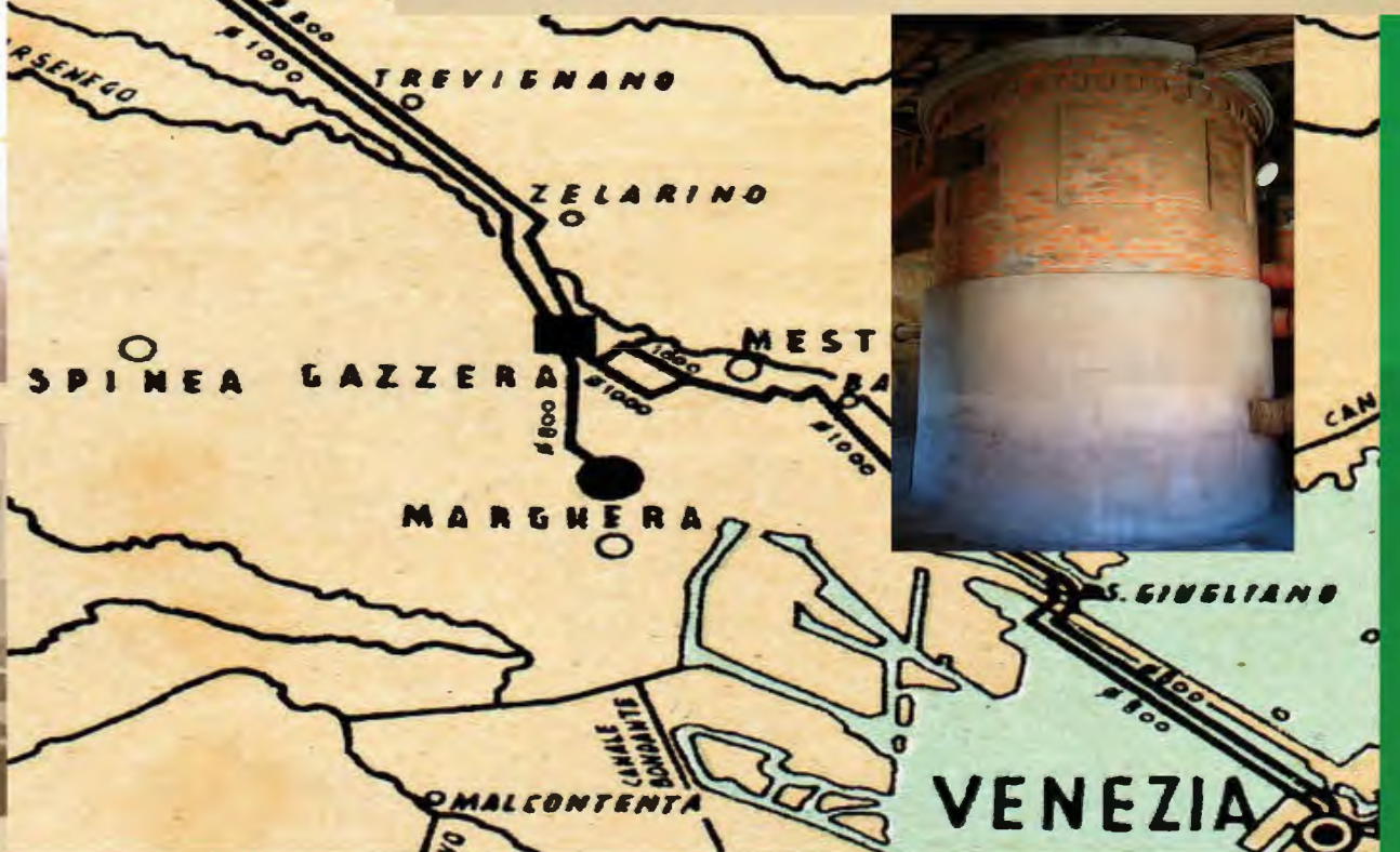
Torre piezometrica alla Gazzera per l'incrocio delle due condotte adduttrici \varnothing 800 e \varnothing 1000 mm.
